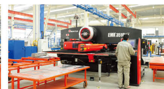
Линия по обработке стального листа AMADA
